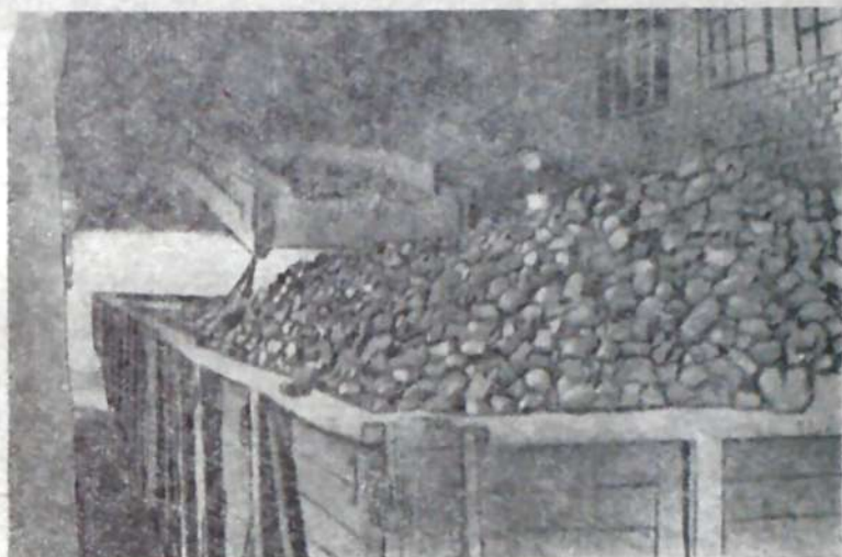
Рис. 5. Кумертауская углебрикетная фабрика. Погрузка брикетов в вагоны погрузочным транспортером. Фото М. Маркелова.
